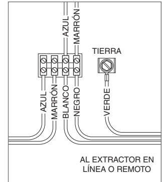
Cableado del extractor en línea | remoto.
